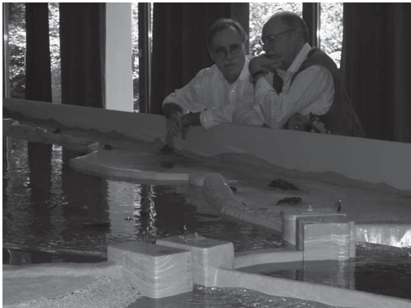
Abb. 7: Hamburger Modell von Mabnā al-Ḥašrağ mit A1 und A2 im Vordergrund. Der Initiator dieser wertvollen Fließversuche M. Schütz (links) begutachtet mit W. Herberg die Vorgänge kurz vor dem Überfließen der Mauer C. (Aufnahme: Ueli Brunner)
