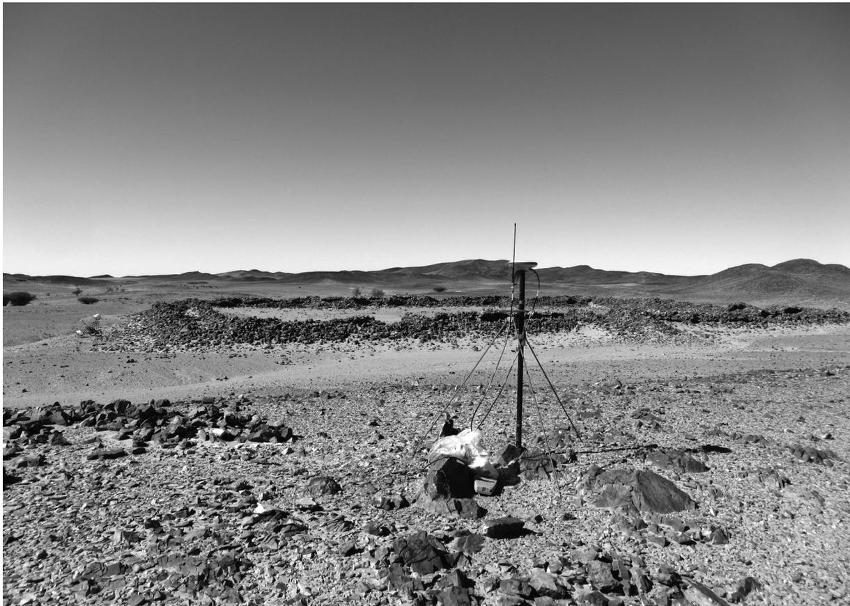
Abb. 3: In der Nähe des Meßfeldes aufgebaute GPS-Basis-Station.
