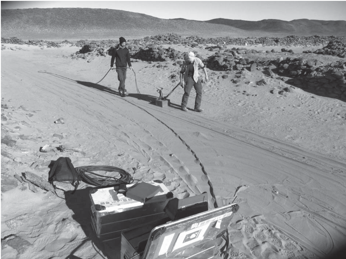
Abb. 4: Georadar-Antenne (400 MHz) im Hintergrund und Georadarapparatur SIR-3000 im Vordergrund.
