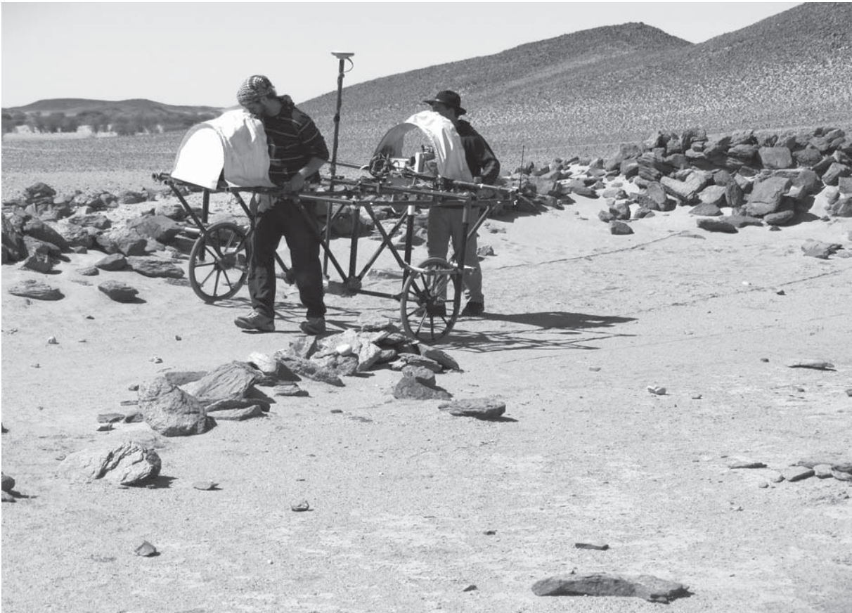
Abb. 2: Messwagen mit 6 Magnetiksonden (Mitte), Navigationsrechner (vorne) und Datenlogger (hinten).
