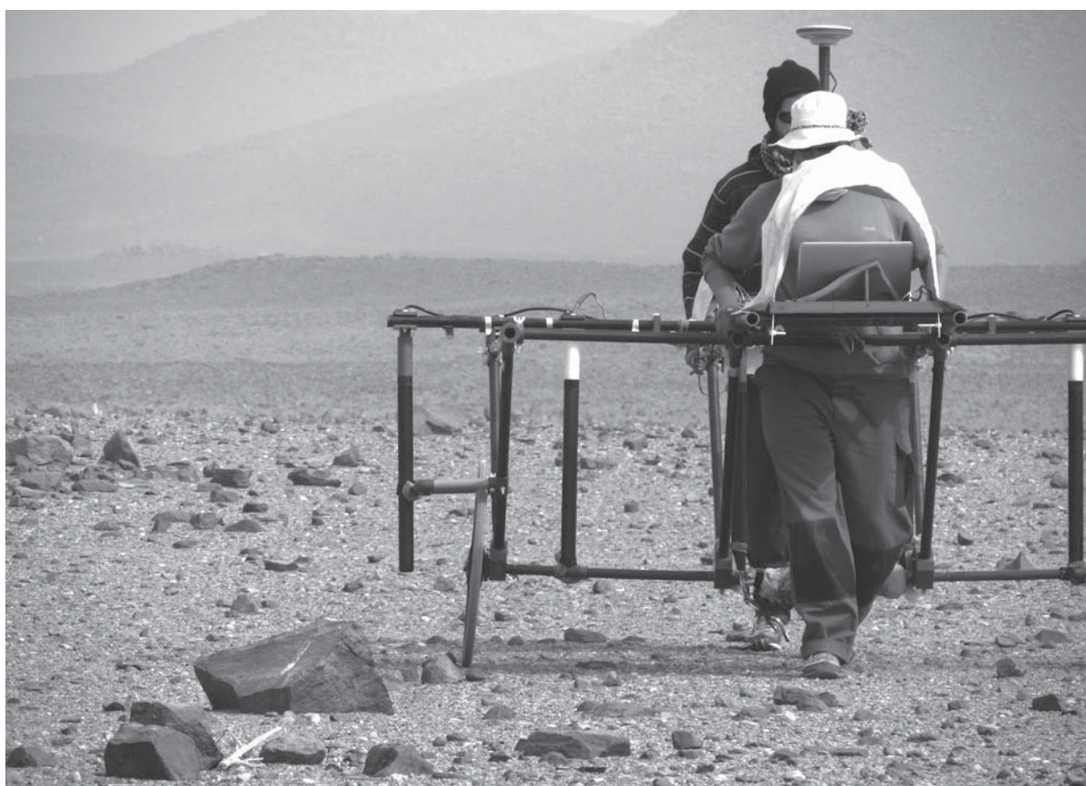
Abb. 10: Geomagnetische Messungen am Site 205.
