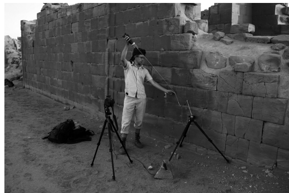
Abb. 3: Hembo Pagi beim Durchführen einer RTI-Aufnahmeserie an der Wand 513/517. Die Entfernung des Blitzes von der Wand beim Beschreiben des ‚virtuellen Lichtdoms‘ wird durch Einsatz eines Seils konstant gehalten (Foto: C. Kleinitz).
