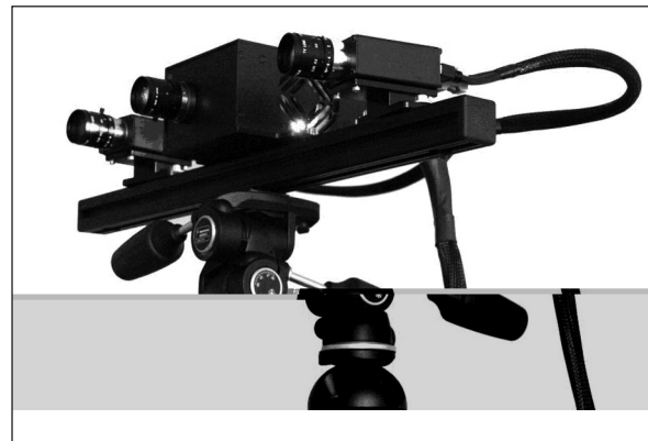
Abb. 9: Der Streifenprojektionsscanner (Foto: T. Bauer).
