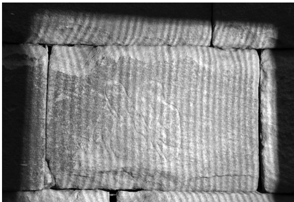
Abb. 11: Projektion von Lichtstreifen auf das ‚Biertrinker‘-Graffito, Wand 204/202N (Foto: C. Kleinitz).
