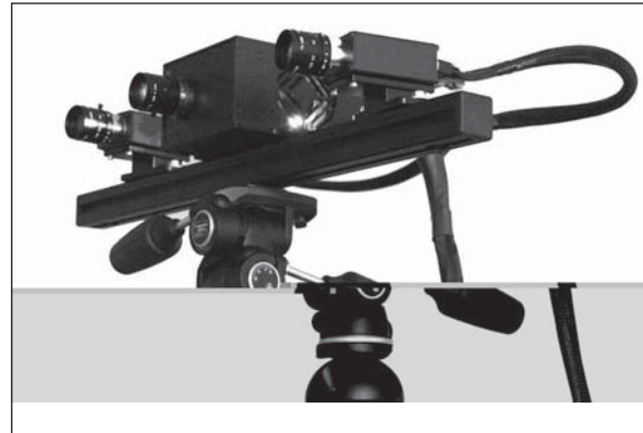
Abb. 9: Der Streifenprojektionsscanner (Foto: T. Bauer).
