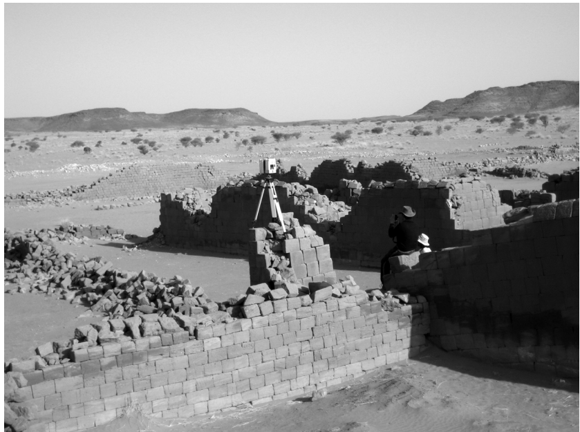
Abb. 5: Der HDS-6000 auf einer Mauerkrone im Komplex 500 der Großen Anlage (Foto: Stephen Wessels).
