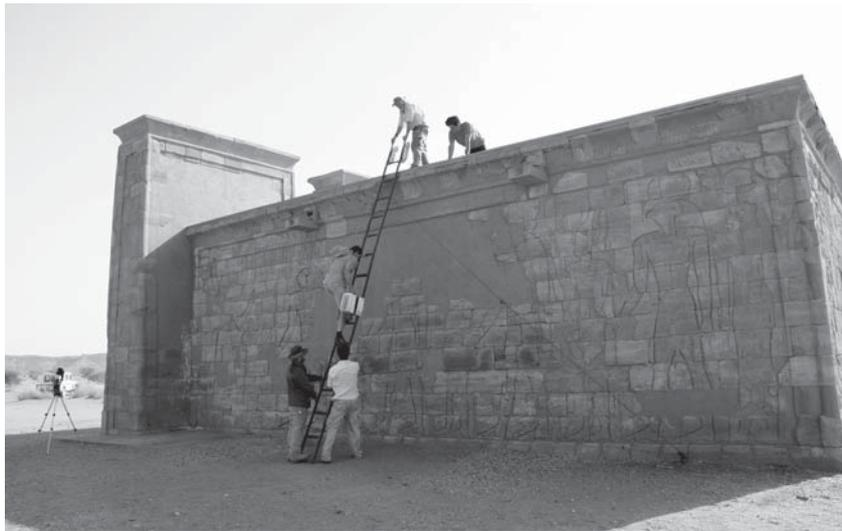
*targets* wurde jedoch im Falle der Großen Anlage – für deren Aufnahme insgesamt ca. 360 Einzelscans nötig waren – als zu zeitaufwändig erachtet und durch die Orientierung mittels geometrischer Oberflächenmerkmale ersetzt. Auch wurden die Scanpositionen und diagnostischen Architekturelemente durch das sehr präzise RTK-GPS registriert (Wessels 2009).
