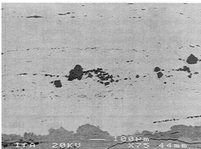
Abb. 10: REM-Aufnahme von Schlackeneinschlüssen in der Eisenplatte (Probe 7). Wiederum ist die zeilenförmige Ausrichtung der Schlacke infolge der starken Verformung beim Schmiedeprozess zu erkennen. Hervorzuheben sind die extrem harten Einschlüsse von Spinell, die sich dieser Verformung erfolgreich widersetzen (Mitte und rechts).
