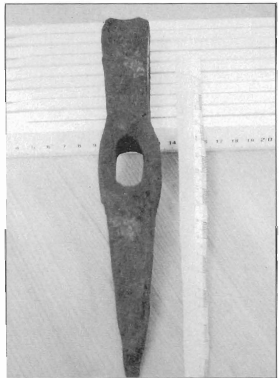
Abb. 3: Römische Keilhaue. Zusammen mit Setzkeilen verwendet beim basalen Lösen von Rohblöcken im Sandsteinbruch „Kriembildensstuhl“ bei Bad Dürkheim mit röm. Betrieb um 200 n. Chr. (Replik im Deutschen Bergbau-Museum, Bochum).
