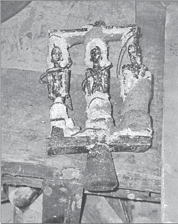
Abb. 7: Freilegen der Rohgüsse. Erkennbar ist der Armiierungsdraht, der zur Stabilisierung beim Formenaufbau eingeflochten wurde.
