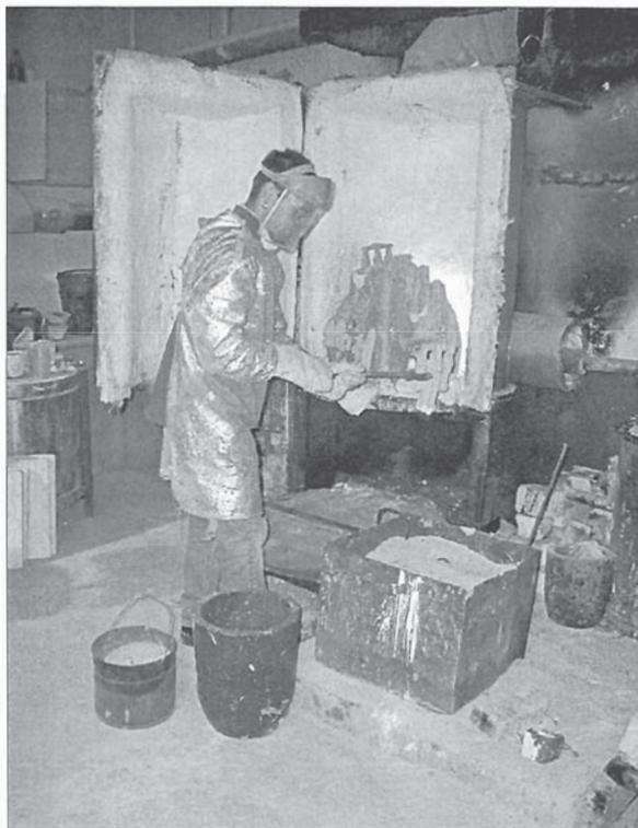
Abb. 6: Entnahme der heißen Gußformen aus dem Glühofen.
