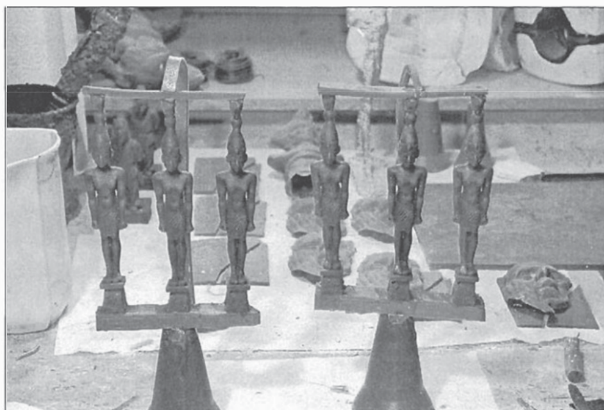
Abb. 4: Je drei Wachsmodelle werden mit einem gemeinsamen Einguß- und Abluftsystem versehen.
