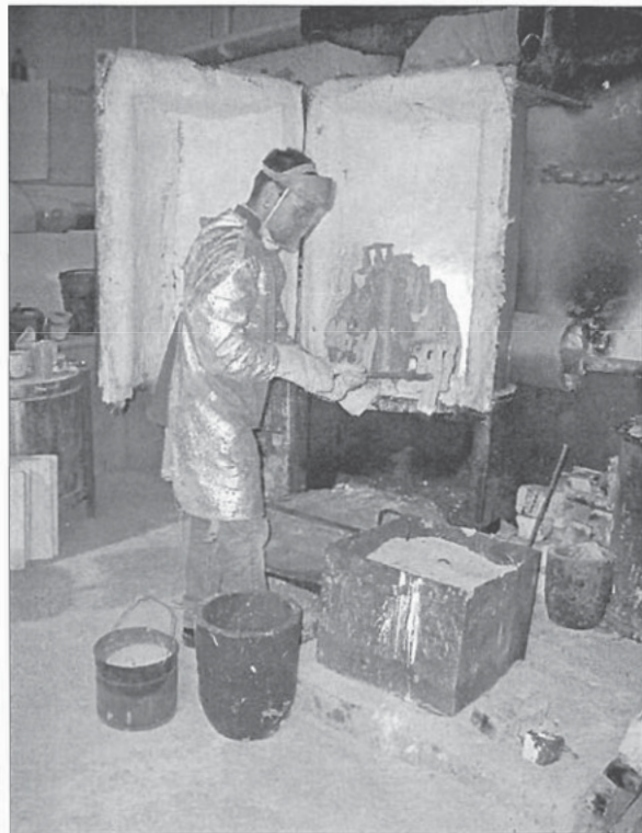
Abb. 6: Entnahme der heißen Gußformen aus dem Glühofen.
