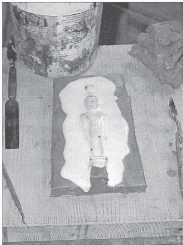
Abb. 2: Aufbringen der ersten Schicht Silikonkautschuk beim Abformen.
