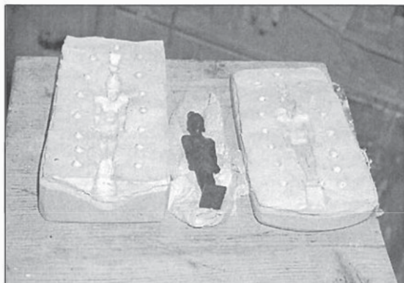
Abb. 3: Die geöffnete Silikonkautschukform mit dem entnommenen Original.
